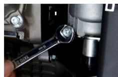
6. Laissez le carburant s'écouler dans le récipient jusqu'à ce qu'il n'en reste plus. Resserrez le boulon de vidange en place.
