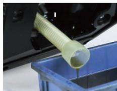
4. Placez un récipient sous le trou de vidange et inclinez la machine pour permettre à l'huile de s'écouler. Une fois vidangée, resserrez le bouchon de vidange en place.
